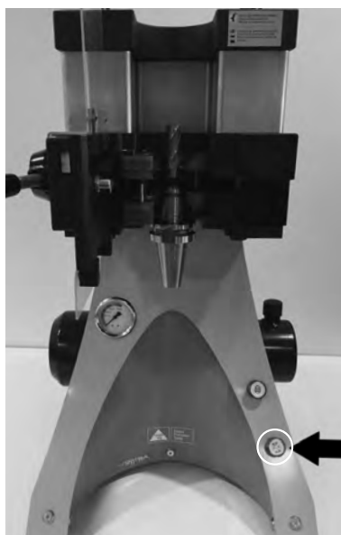
ツーリングを入れた後 扉を閉めて圧入ボタンを押す
